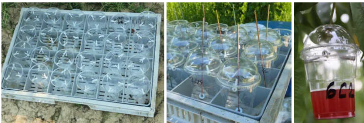
Série nenaplněných kelímkových lapáků (vlevo nahoře bez víček, pohled shora, dole boční pohled na lapáky s víčkem) a lapák naplněný návnadou (vpravo).
